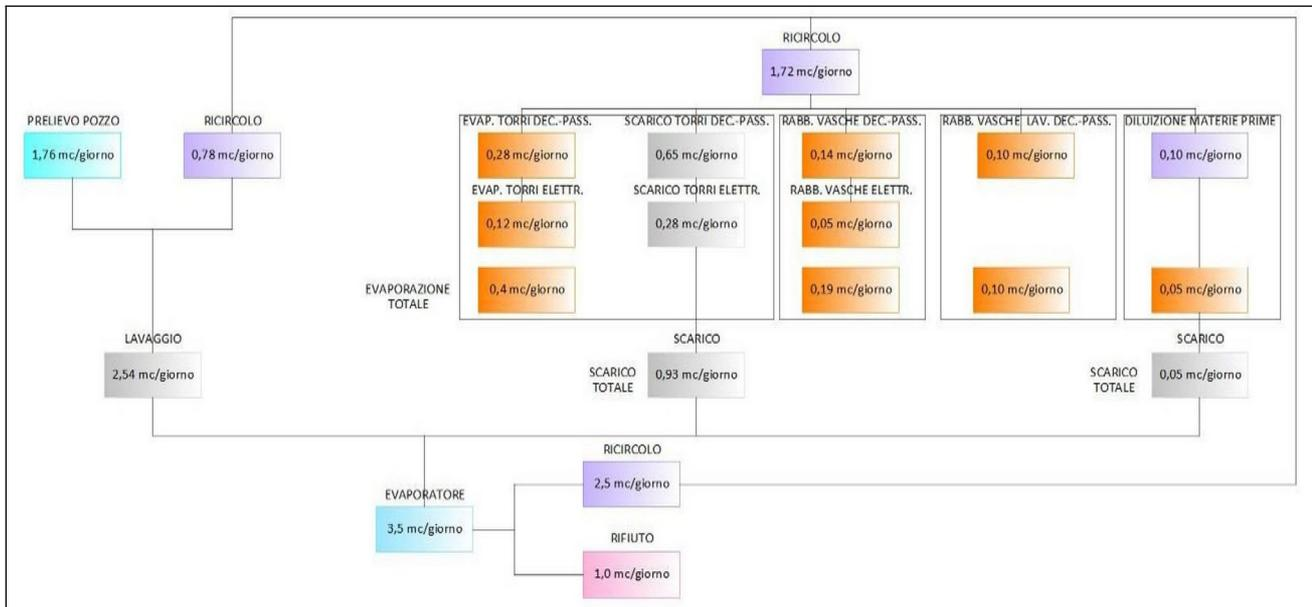
Dal trattamento con evaporatore si ottengono perdite per evaporazione, trascinalimento e umidità sui manufatti lavati pari a 191 mc/anno corrispondenti a 0,74 mc/giorno; si ottengono inoltre 917,8 mc/anno di reflui (pari alla capacità di trattamento annuo dell'evaporatore) pari a ca. 3,5 m<sup>3</sup>/giorno, di cui circa il 70% sarà impiegato per il ricircolo (2,5 mc/g) mentre circa il 30% andrà gestito come rifiuto (1 mc/g).
