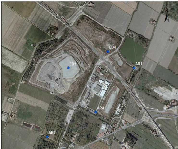
Planimetria Area 3 via Caruso: rete di monitoraggio emissioni diffuse e qualità dell'aria
