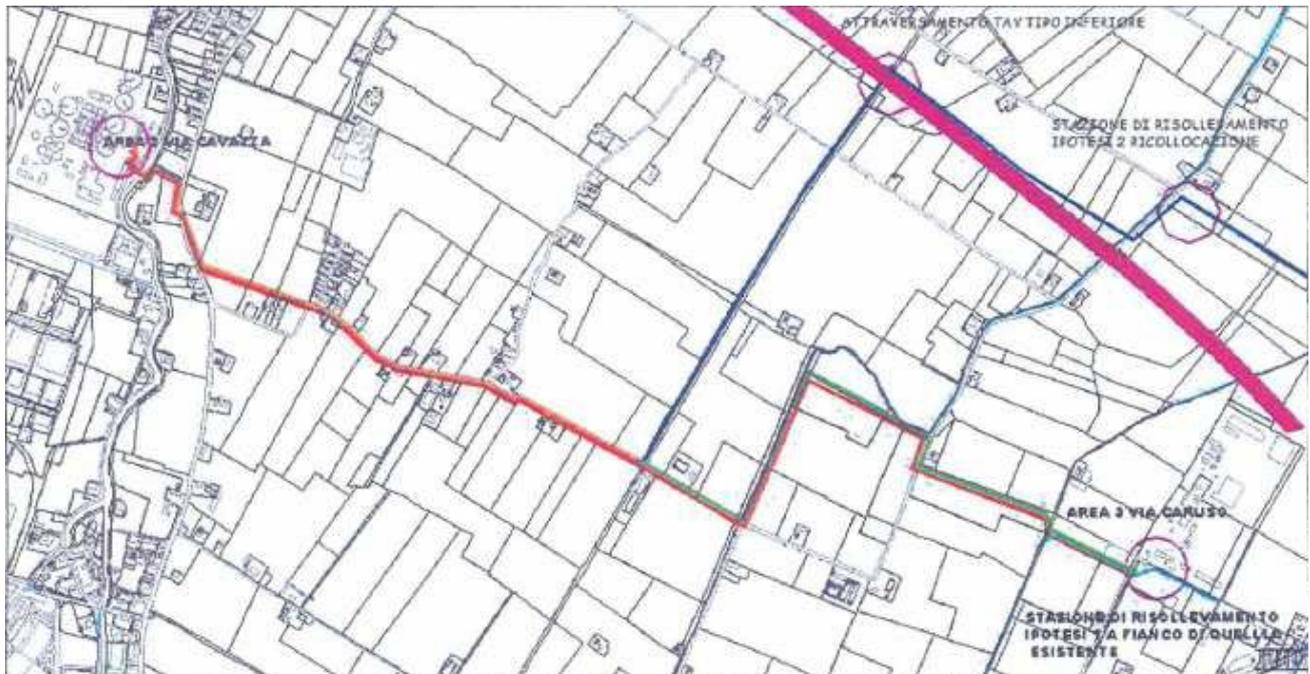
Le tubazioni di adduzione del percolato alle relative stazioni di sollevamento, sono dotate ciascuna di saracinesca atte ad escluderne l'utilizzo; inoltre entrambi i percolatodotti (vecchio da 20 mc/h e nuovo da 60 mc/h) sono dotati di misuratore di portata in partenza ed in arrivo e pozzetto di campionamento.
