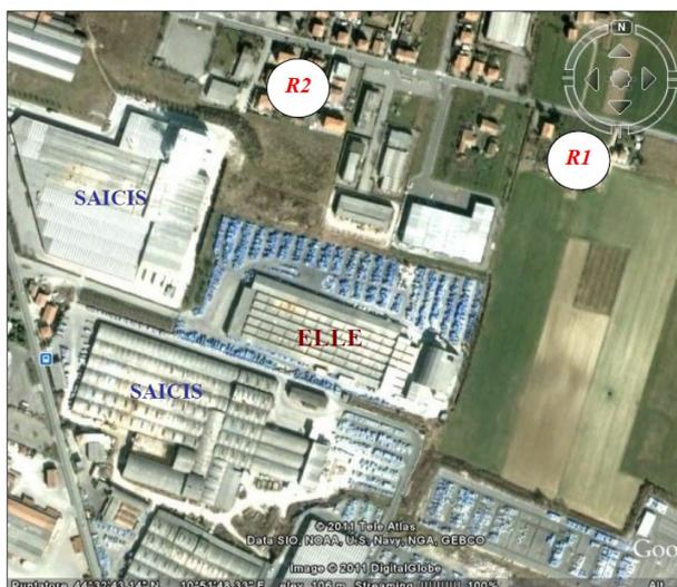
Entrambi i recettori ricadono in area di classe acustica III (limite diurno di 60 dBA, limite notturno di 50 dBA).
