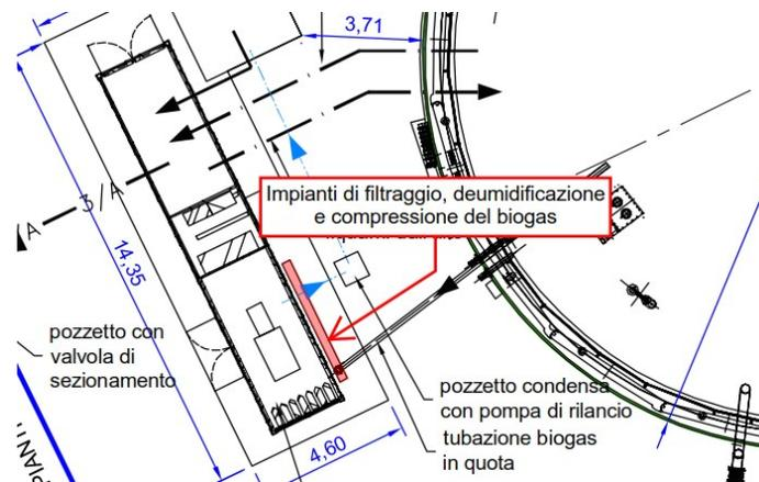
I trattamenti di filtraggio e deumidificazione del biogas migliorano il rendimento di combustione e ampliano i periodi di tempo che intercorrono tra una manutenzione e l'altra del cogeneratore.
