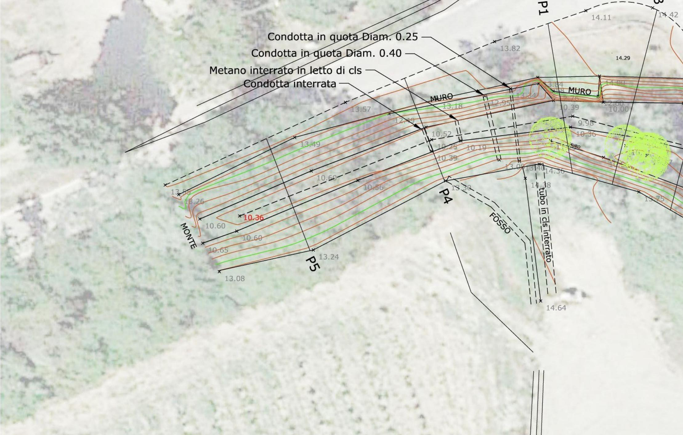
Figura 7 - **Planimetria di rilievo** sovrapposta a foto aerea - Scala 1:250
