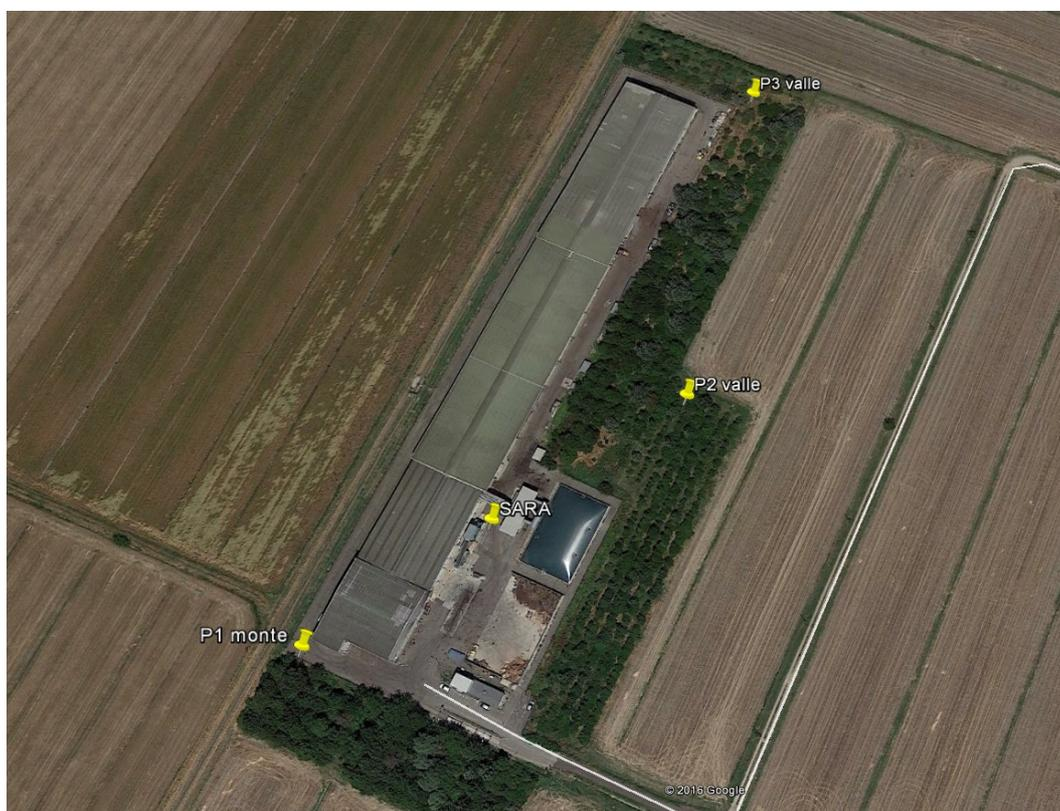
*Figura 1 - Planimetria Impianto di compostaggio SARA di Nonantola con la rete di monitoraggio dei piezometri da realizzare (ubicazione indicativa).*
