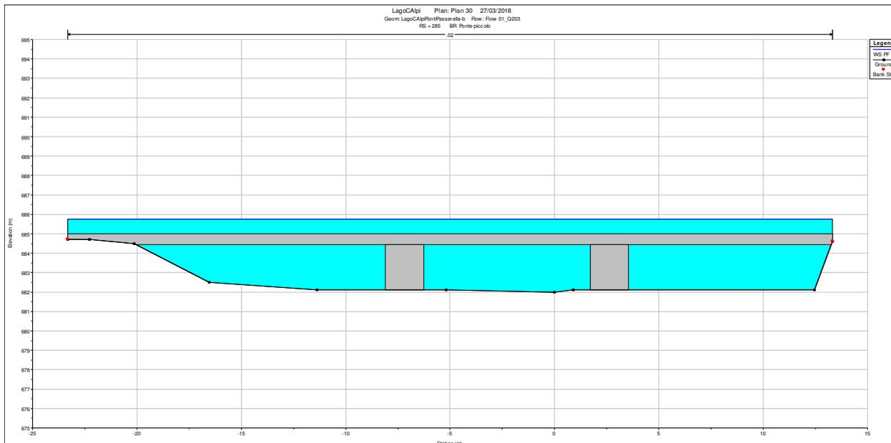
Figura 17 – Livello di piena simulato in corrispondenza del ponte piccolo con  $Q_{200}$
