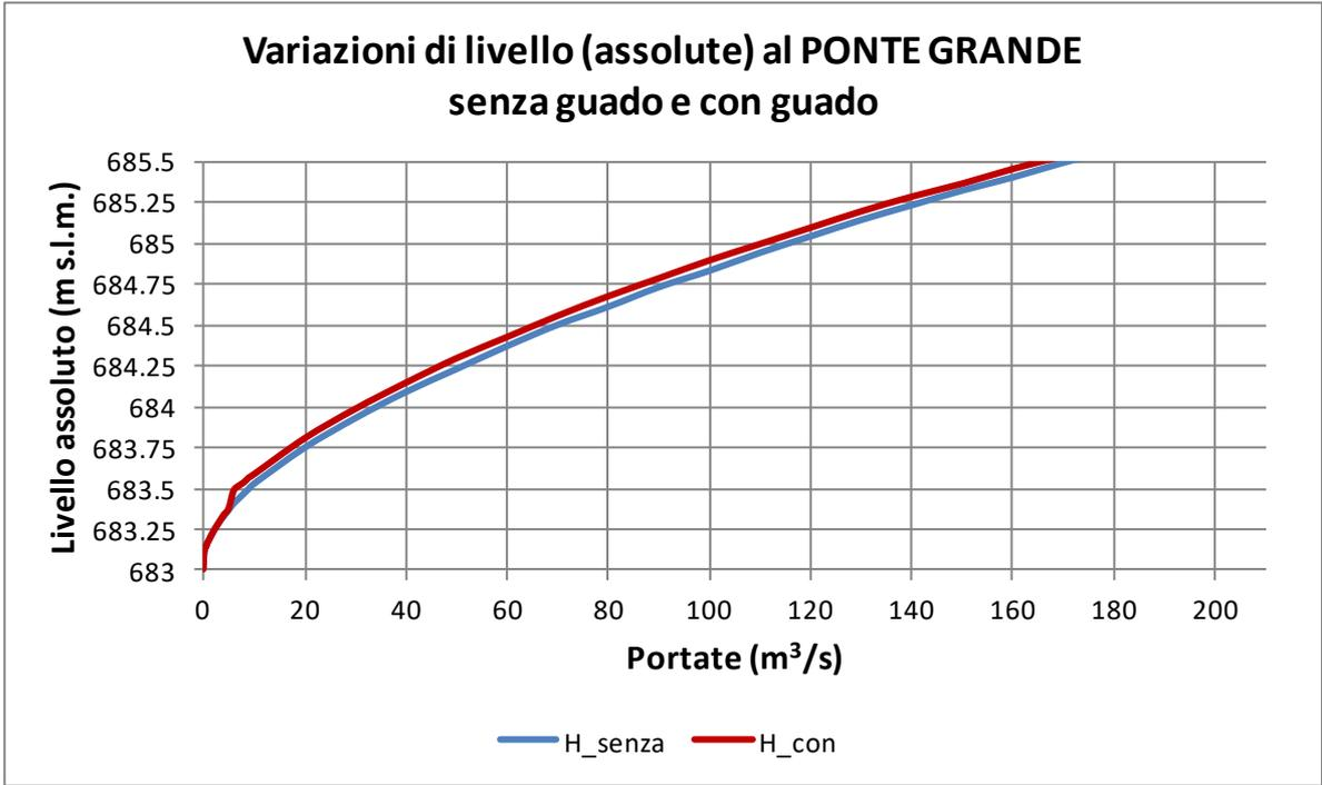
Figura 22 – Variazioni di livello assolute al ponte grande, per effetto della costruzione del guado
