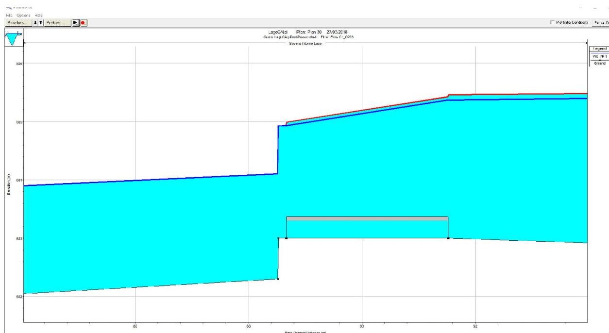
Figura 19 – Profili idraulici nella situazione senza (blu) e con (rosso) guado ( $Q_{200}$ )
