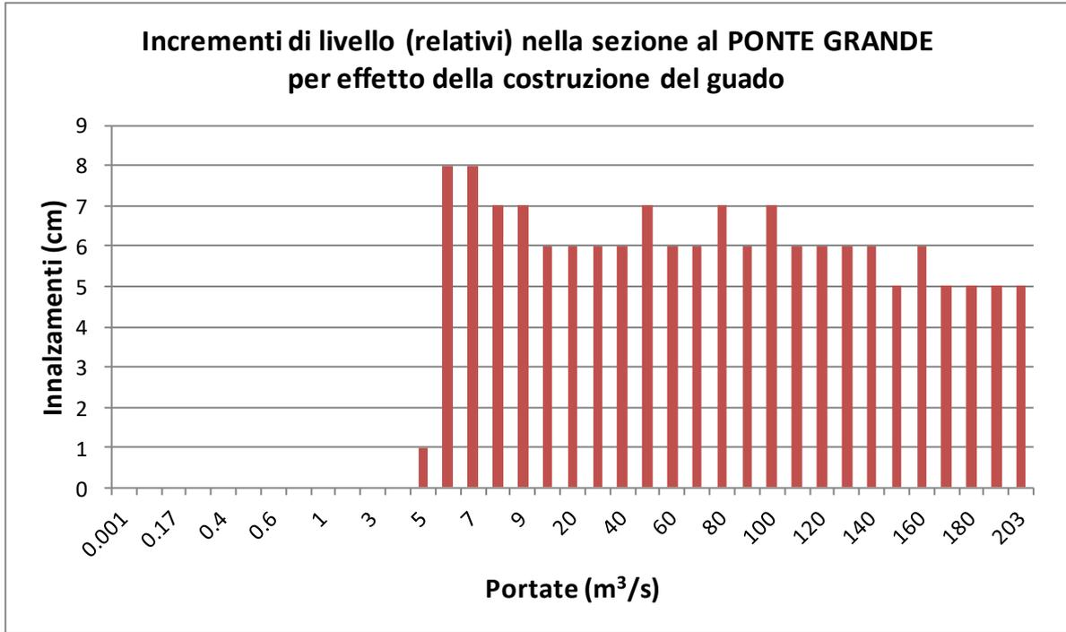
Figura 25 – Incrementi relativi di livello al ponte grande per diversi valori di portata
