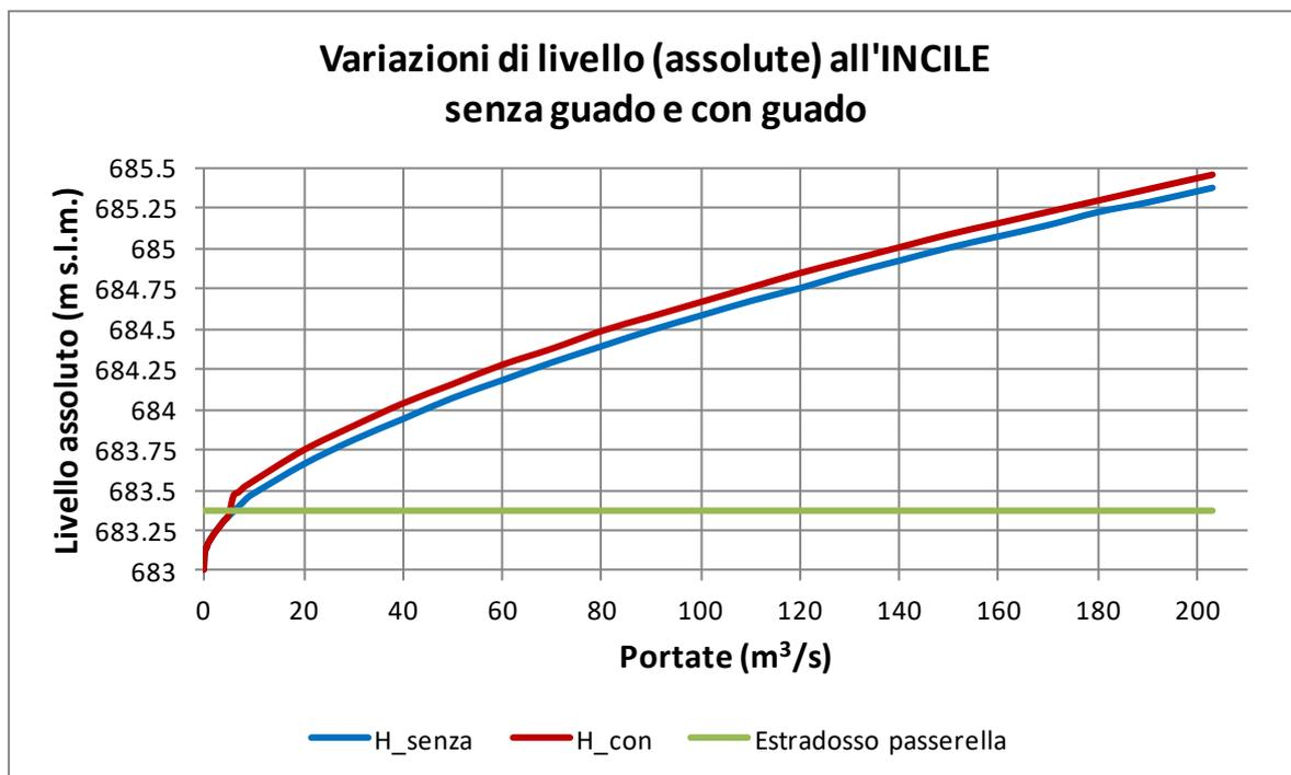
Figura 23 – Variazioni di livello assolute all'incile del lago, per effetto della costruzione del guado
