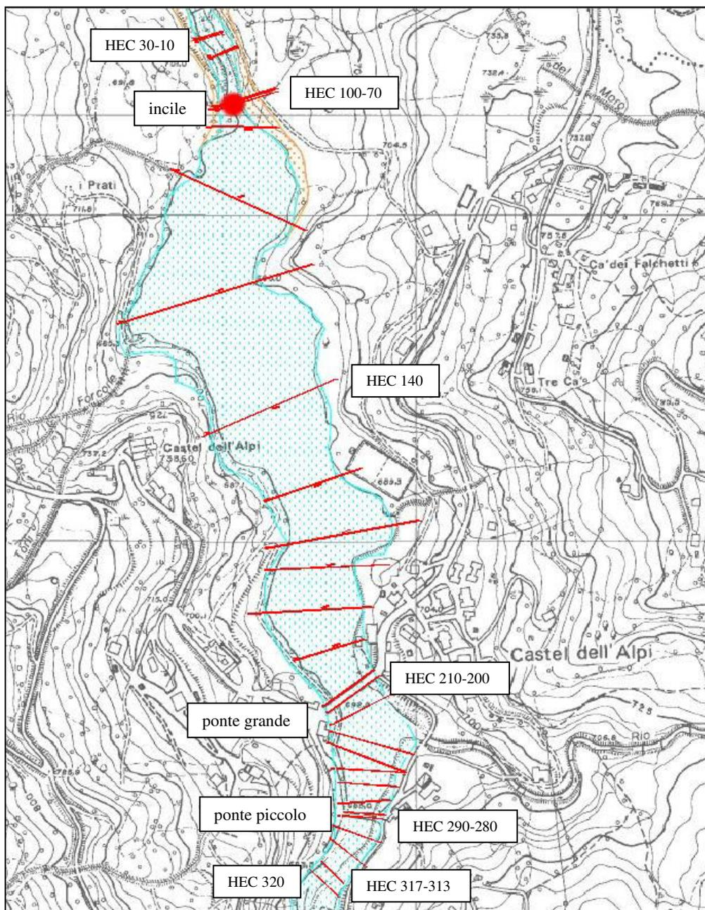
Figura 11 – Tracce delle sezioni per la simulazione
