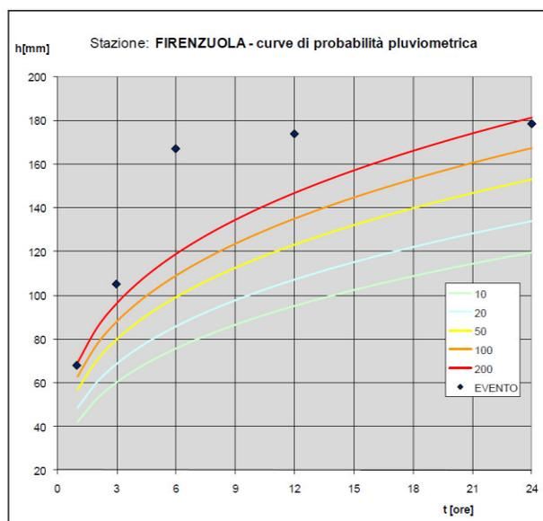
Figura 9 – Curve di probabilità pluviometrica – Fonte A.R.P.A. Emilia-Romagna – Servizio IdroMeteoClima
