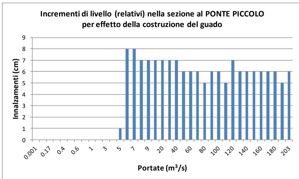
Figura 24 – Incrementi relativi di livello al ponte piccolo per diversi valori di portata
