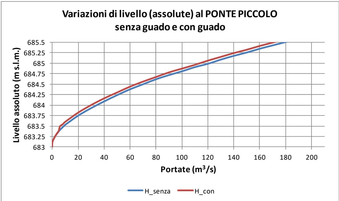
Figura 21 – Variazioni di livello assolute al ponte piccolo, per effetto della costruzione del guado
