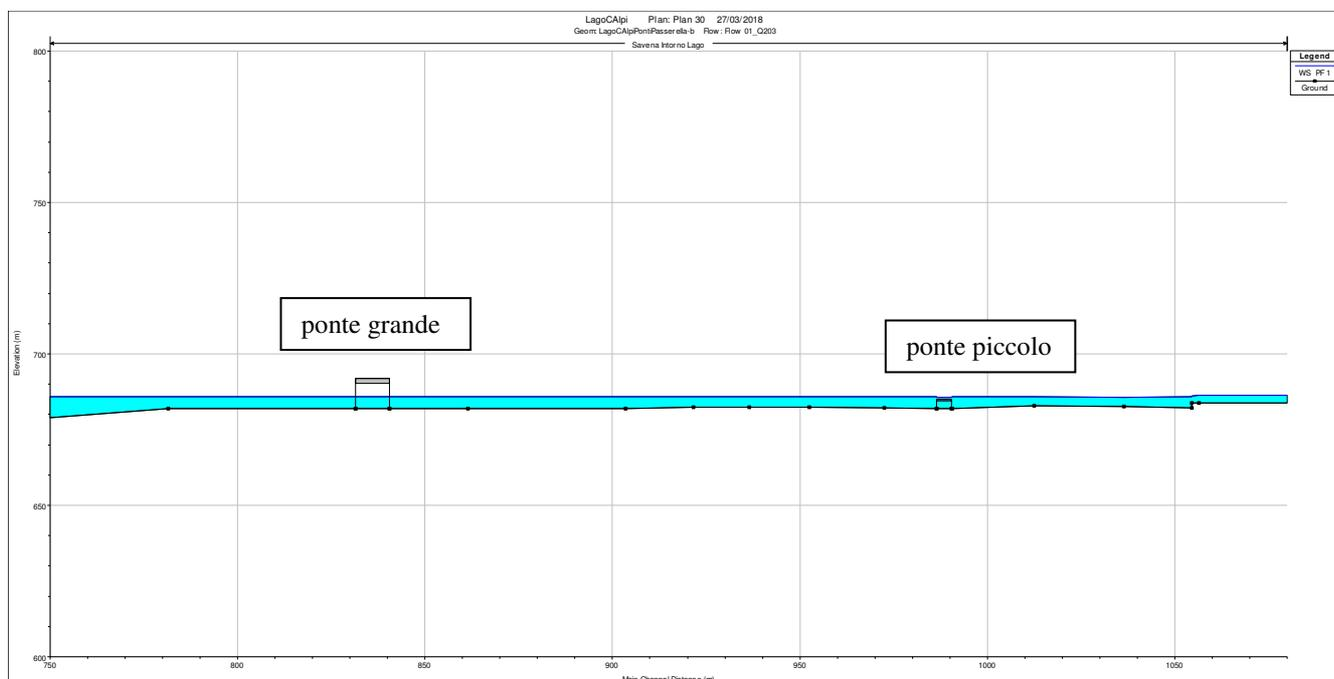
Figura 16 – Profilo livelli idrici con  $Q_{200}$  in corrispondenza dei ponti (tratto di 310 m)
