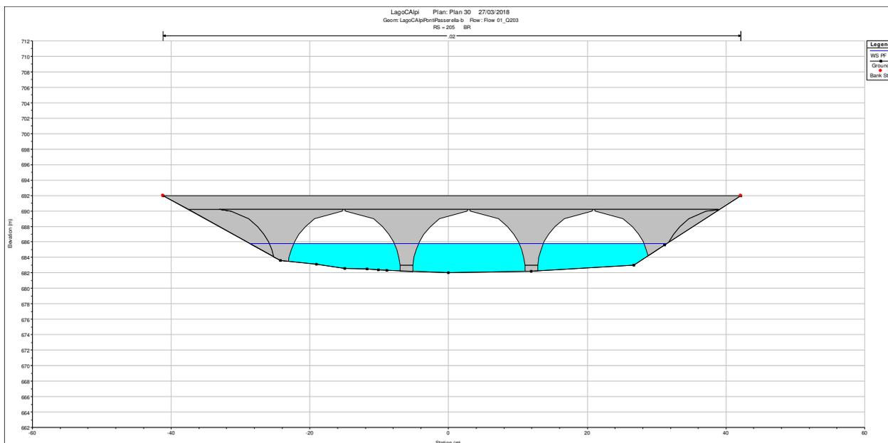
Figura 18 – Livello di piena simulato in corrispondenza del ponte grande con  $Q_{200}$
