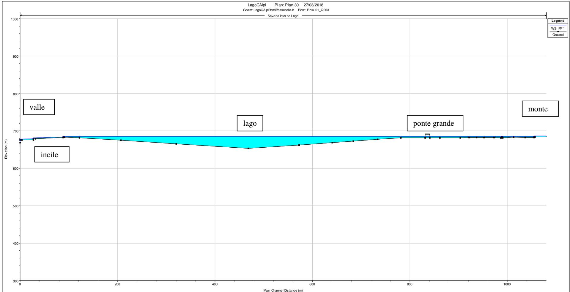
Figura 15 – Profilo del pelo libero, livelli idrici con  $Q_{200}$  nell'intero tratto simulato (1080 m)
