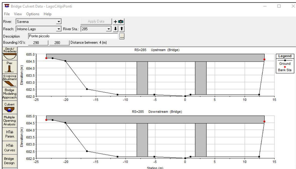
Figura 14 – Dati geometrici del ponte piccolo
