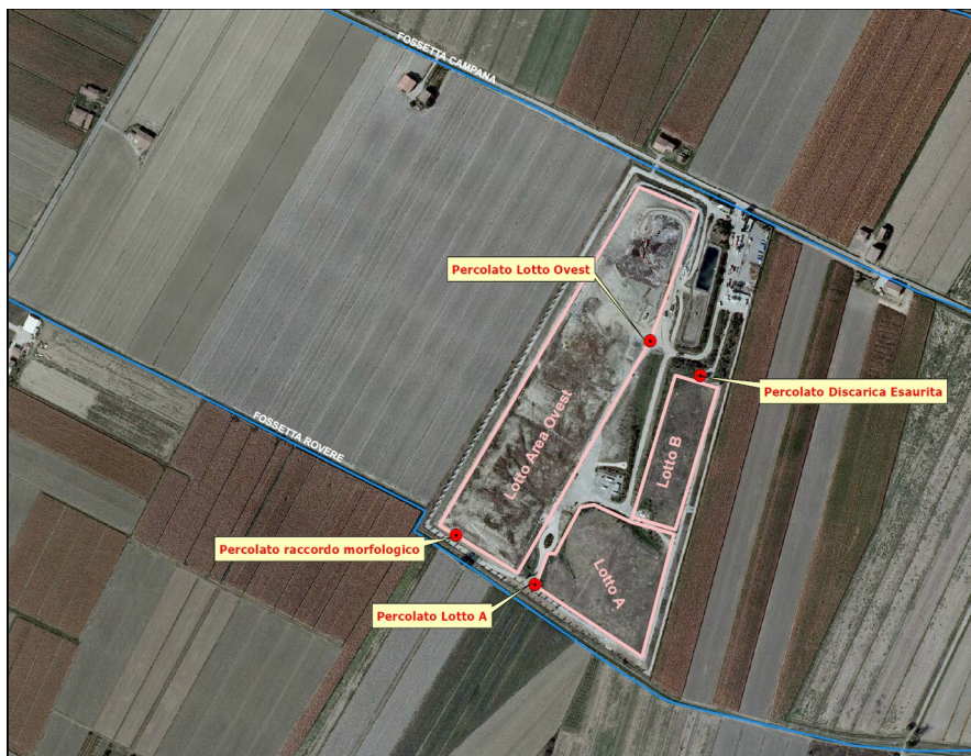
Planimetria Discarica di Aimag di Medolla con rete di monitoraggio delle acque di percolazione.
