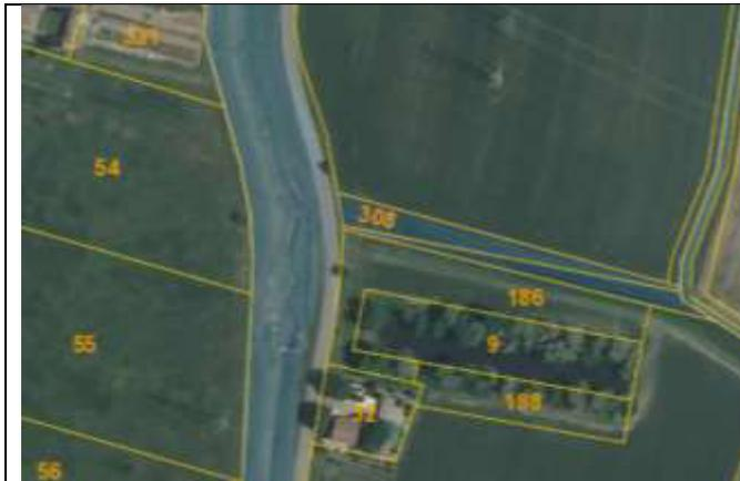
Fig. 5) Estratto di mappa catastale Fg. 49 comune di Anzola dell'Emilia (BO) sovrapposto a Fotopiano in corrispondenza del torrente Ghironda/Calvanella ove si rilevano le aree del demanio idrico (azzurro) che comprendono il corpo arginale e la strada.
