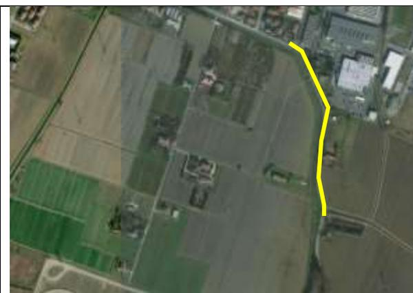
Fig. 1) Fotopiano con individuato il tratto di condotta in progetto (in colore giallo).
