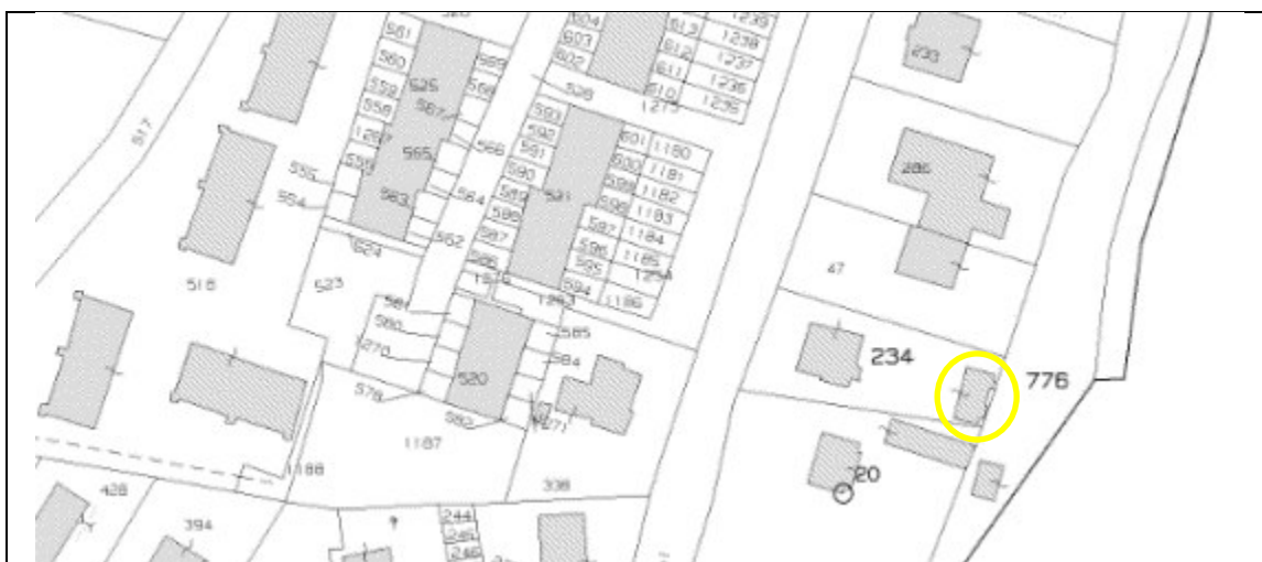
Figura 1) Estratto di mappa del Fg. 44 in comune di Monte San Pietro (BO). In colore giallo si evidenzia il corpo di fabbrica (Fg. 44 mapp. 234) rappresentato al limite del confine demaniale, ma che in realtà risulterebbe traslato o ampliato in parte su fg. 44 mapp. 776
