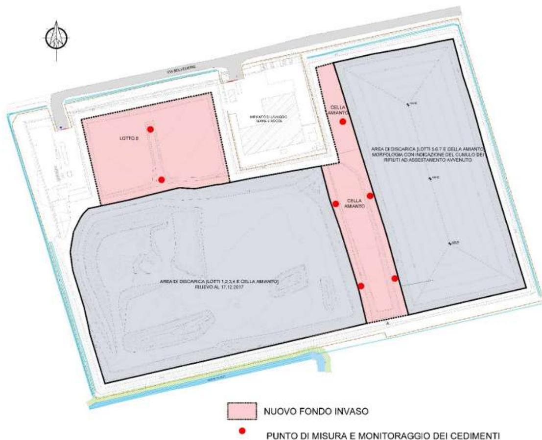
Fig. 3 – Planimetria con possibile distribuzione dei punti di monitoraggio del fondo di nuovo approntamento
