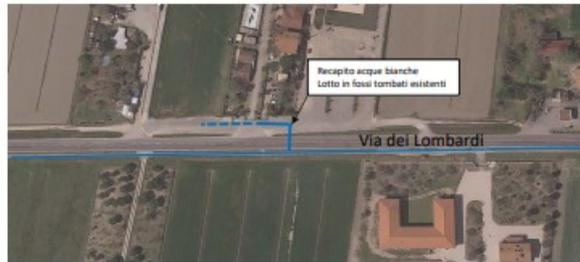
Figura 3: Schema delle reti fognatura bianca esistenti lungo la via dei Lombardi.
