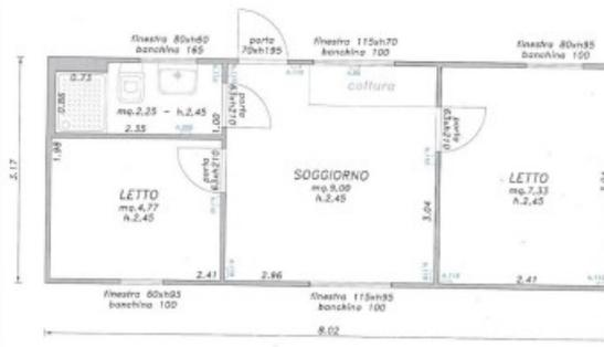
Figura 6: Scheda tipologica di casetta mobile.
