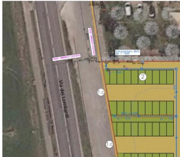
Figura 2: Inquadramento su ortofoto di dettaglio del punto di scarico acque meteoriche del lotto in fosse tombinate stradale.
