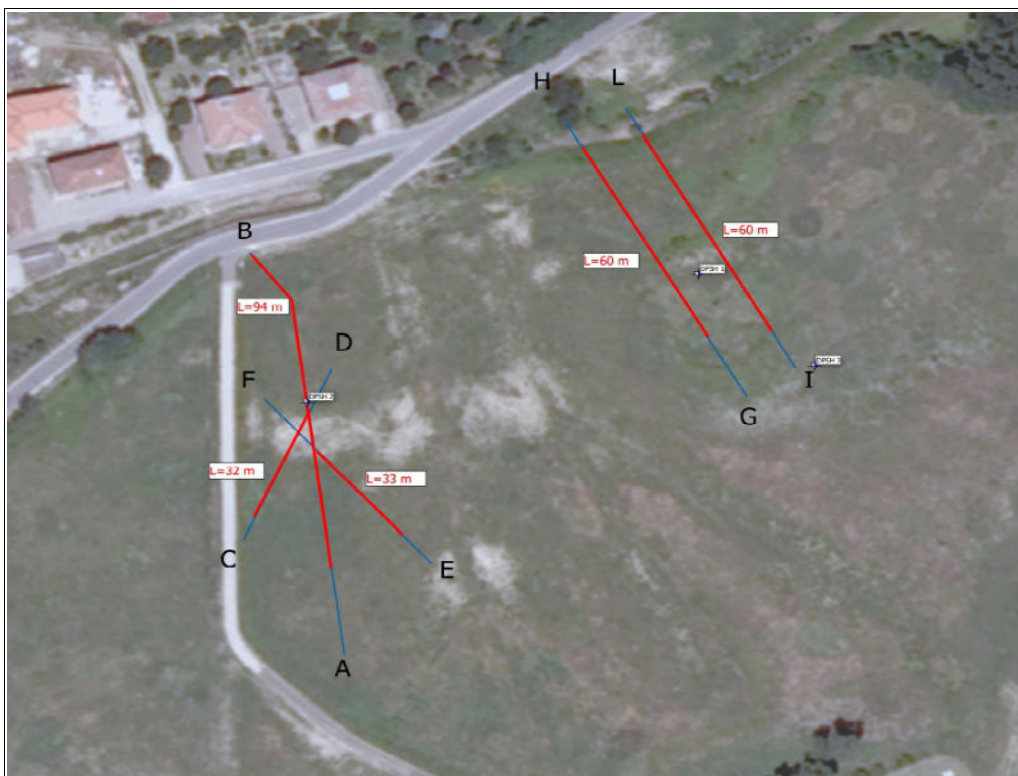
Inquadramento di dettaglio dell'area di studio (base CTR 1:5,000). Le linee rosse indicano le trincee drenanti in progetto. Sono anche indicate in pianta le relative tracce di sezione topografiche.
