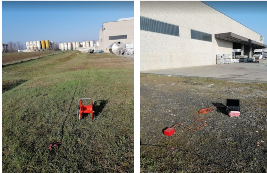
Figura 3. Stendimento sismico (a sinistra) e acquisizione HVSr (a destra).
