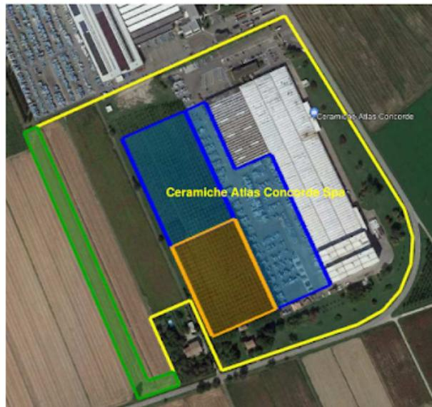
Per la gestione delle acque superficiali derivanti dal dilavamento della nuova superficie impermeabilizzata, si prevede la realizzazione di un bacino di laminazione di capacità pari a circa 3.207 mc per garantire l'invarianza idraulica.
