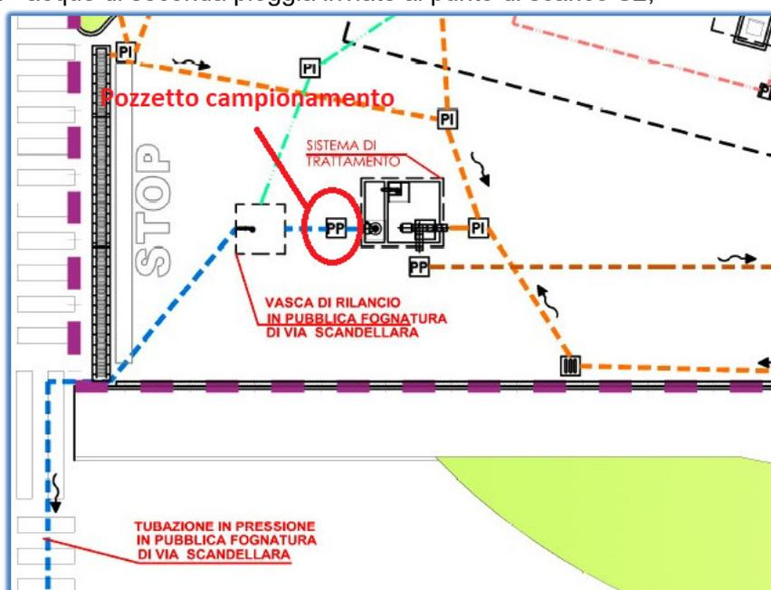
3. rete di raccolta delle acque meteoriche non contaminate dei coperti degli edifici e delle pensiline che sono raccolte in un serbatoio per riutilizzo il cui troppopieno è avviato al punto di scarico S2.
