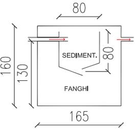
F.A. FILTRO ANAEROBICO 140 X 160 X H 200 cm
