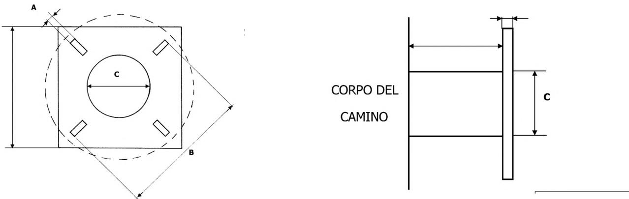
Tronchetto di campionamento necessario per l'utilizzo di sonde isocinetiche combinate e riscaldate per il campionamento di microinquinanti organici. Dettagli costruttivi:
