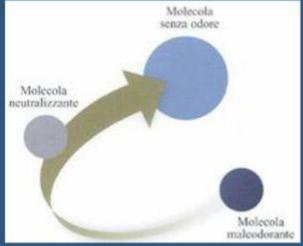
Principio di funzionamento della barriera osmogenica.
