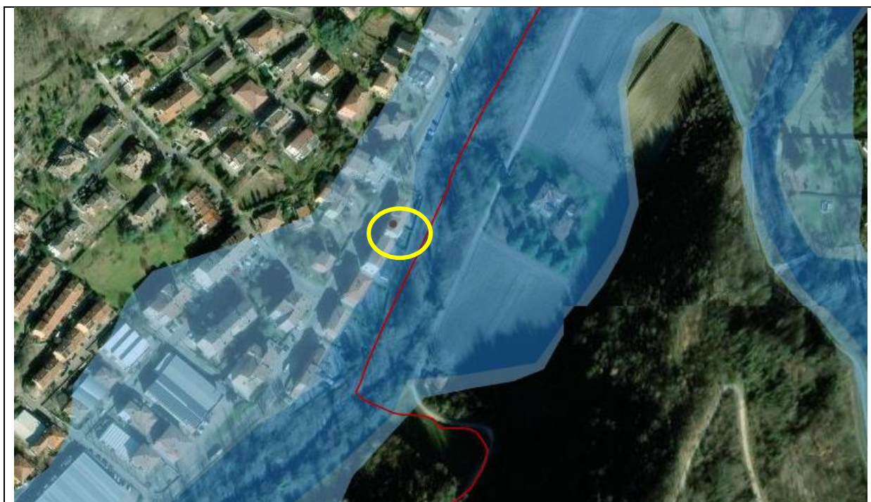
Tavola 3) Direttiva Alluvioni 2019 - in colore celeste scuro le aree con alluvioni frequenti ed in colore più chiaro quelle a moderata probabilità di inondazione (per eventi due centennali) in comune di Monte San Pietro (BO), demaniali mentre in colore giallo l'area oggetto di parere e allibrate nell'estratto di mappa catastale del Fg. 30 mapp.633 p. e parte alveo.
