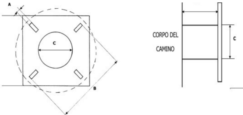
Tronchetto di campionamento necessario per l'utilizzo di sonde isocinetiche combinate e riscaldate per il campionamento di microinquinanti organici. Dettagli costruttivi:
