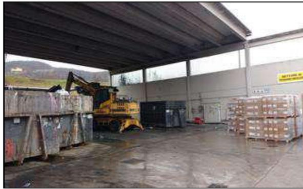
*I rifiuti, per mezzo di un processo di triturazione meccanica, vengono ridotti dimensionalmente e miscelati tra loro all' interno di specifici container. Qui, il materiale viene ulteriormente miscelato ed omogeneizzato al fine di ottenere una miscela di rifiuti solidi che rispetti i criteri di accettazione dell' impianto di GSB*
