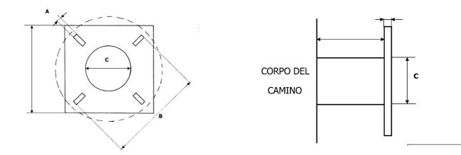
Tronchetto di campionamento necessario per l'utilizzo di sonde isocinetiche combinate e riscaldate per il campionamento di microinguinanti organici. Dettagli costruttivi:
