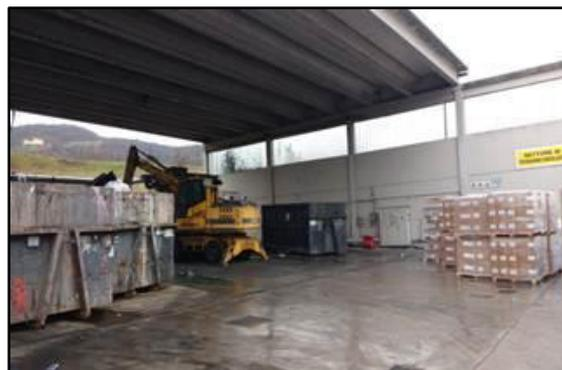
*I rifiuti, per mezzo di un processo di triturazione meccanica, vengono ridotti dimensionalmente e miscelati tra loro all' interno di specifici container. Qui, il materiale viene ulteriormente miscelato ed omogeneizzato al fine di ottenere una miscela di rifiuti solidi che rispetti i criteri di accettazione dell' impianto di Nehlsen Industrieservice GmbH & Co. KG.*
