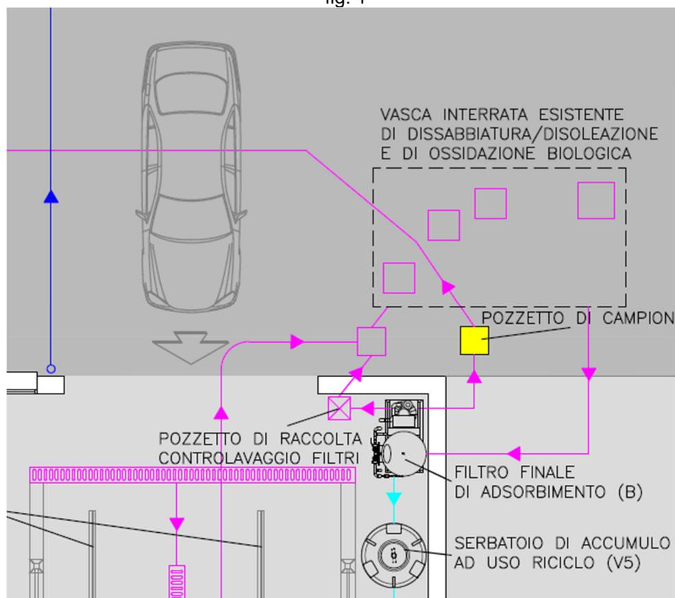
Il refluo dopo il pozzetto di campionamento si immette nella rete interna per essere convogliato allo scarico S1.
