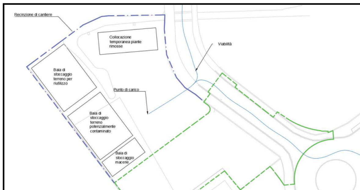
FIGURA 9-1 - LAYOUT DI CANTIERE - AREE DI DEPOSITO
