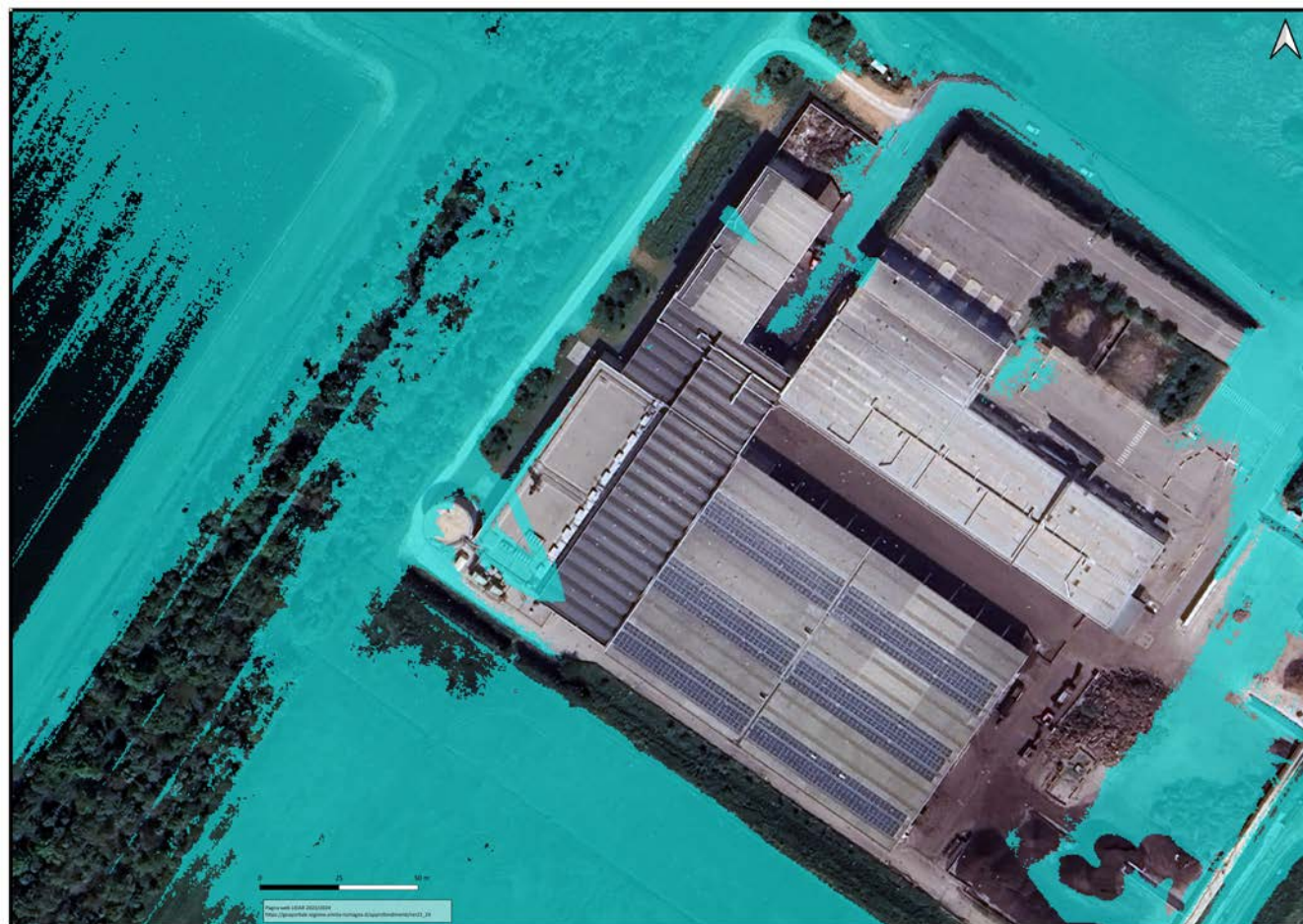
Figura 6 – ricostruzione delle presumibili aree allagate post evento di maggio 2023, in base alle indicazioni fornite da HERA ed al DTM LIDAR RER 2023-2024 (4)
