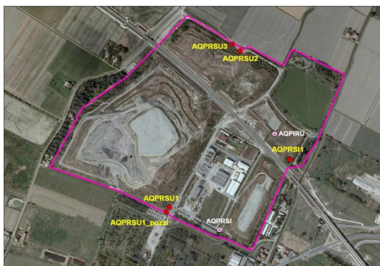
Figura 5 - Planimetria Area 3 via Caruso: rete di monitoraggio percolati
