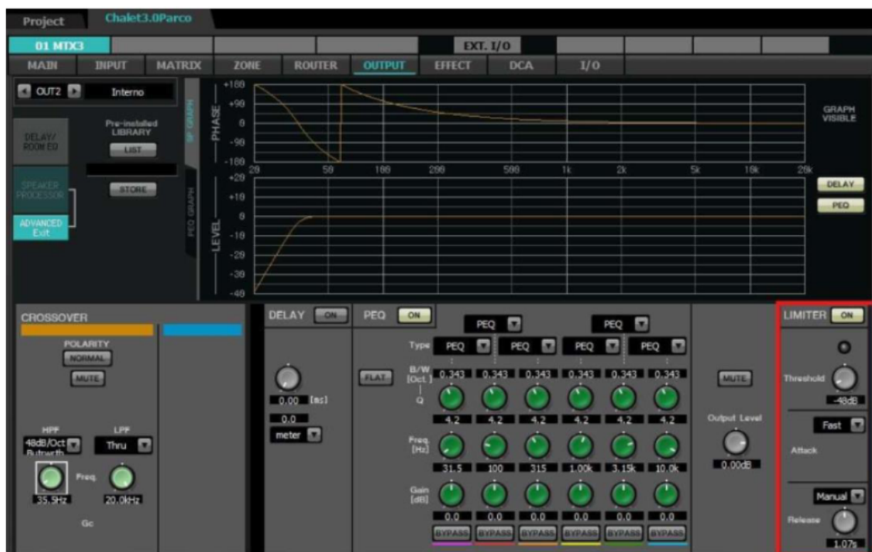
Schermata di configurazione della matrice audio, in cui sono impostati i valori di limiter dopo l'intervento di misura e taratura, per la zona interna a locale
