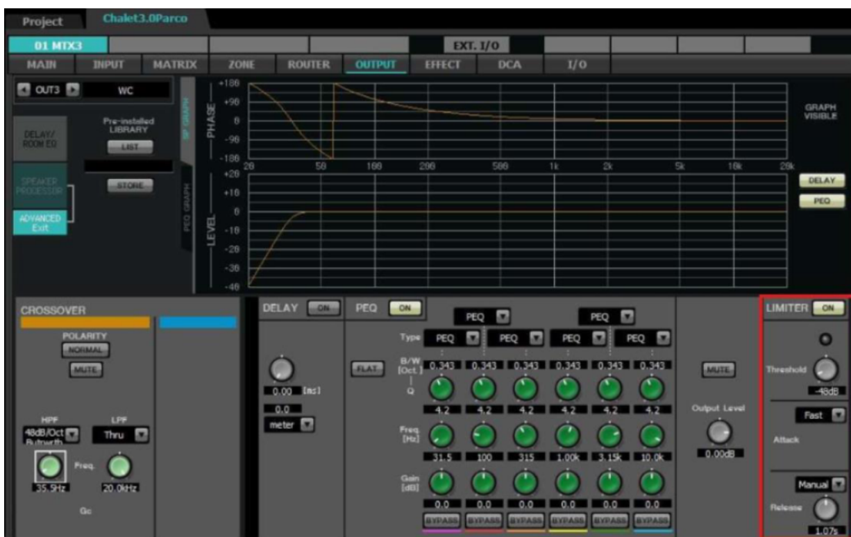
Schermata di configurazione della matrice audio, in cui sono impostati i valori di limiter dopo l'intervento di misura e taratura, per la zona servizi igienici
