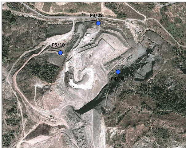
Figura 1 - Planimetria Discarica di Roncobotto (Zocca) con rete di monitoraggio piezometri esistenti
