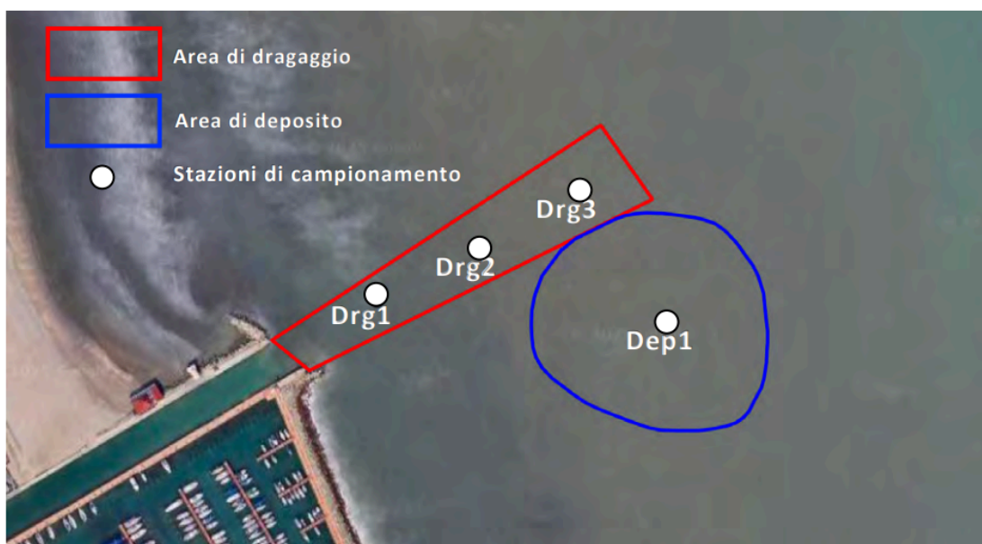
Figura 2: Area di dragaggio, in rosso, e area di deposito, in blu. Nella foto satellitare sono state raffigurate anche le stazioni di campionamento.
