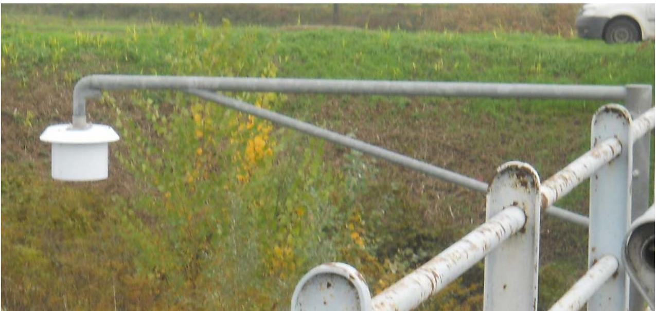
Figura 6 - Bandiera di supporto per idrometro a ultrasuoni (tipologia diversa dalla precedente)
