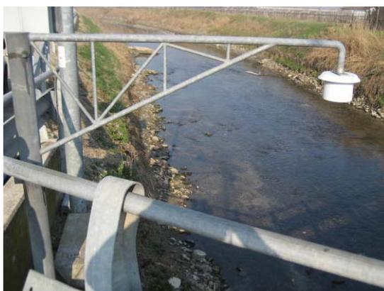
Figura 4 - Supporto a bandiera per idrometro a ultrasuoni
