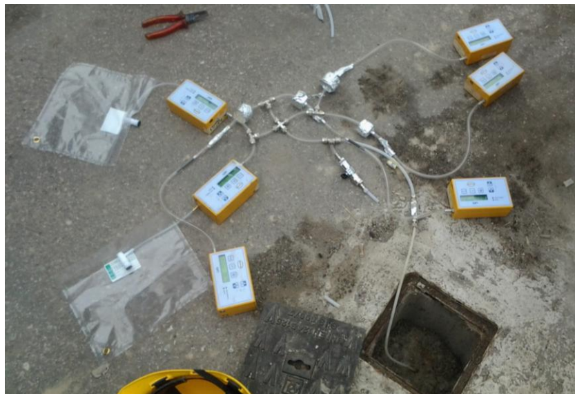
Figura 9 e): Applicazione degli schemi tipo linea di campionamento soil gas di Fig 9 c) e 9 d).
