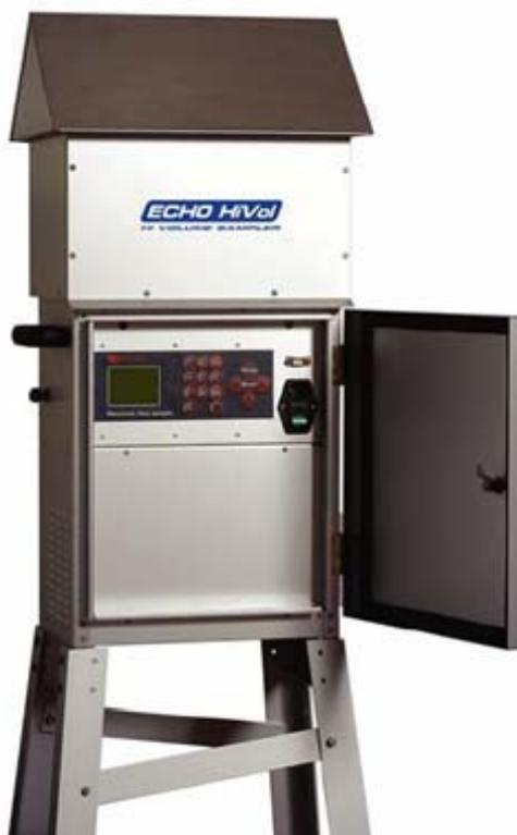
La strumentazione ECHO HI VOL permette il campionamento di PTS o PM 10 per la ricerca di:
