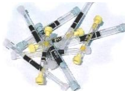
Figura 10: Fiale a desorbimento
