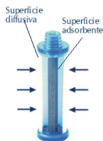
Figura 12: Campionatore a diffusione radiale – Radiello
