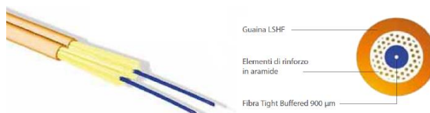
Cavo in fibra ottica di tipo tight
