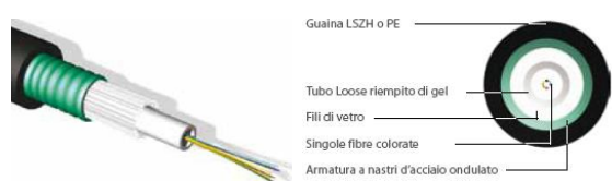
Cavo in fibra ottica armato da esterno
