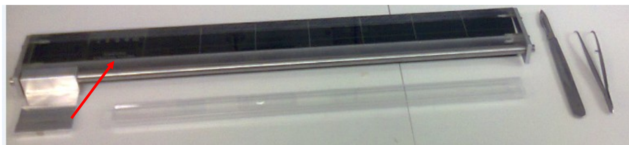
Fig. 4b. Orario di inizio campionamento e taglierina per nastro di campionamento. Esempio di corretto posizionamento e taglio per la suddivisione in porzioni giornaliere di nastro
