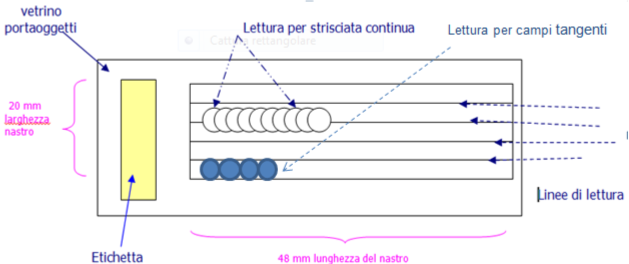
Fig. 5. Esempio di lettura per striscia continua, per campi tangenti e corretto posizionamento per la lettura.
