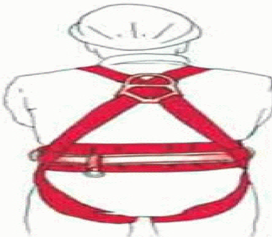
Imbracatura per il corpo con cintura di posizionamento integrata e attacco dorsale
