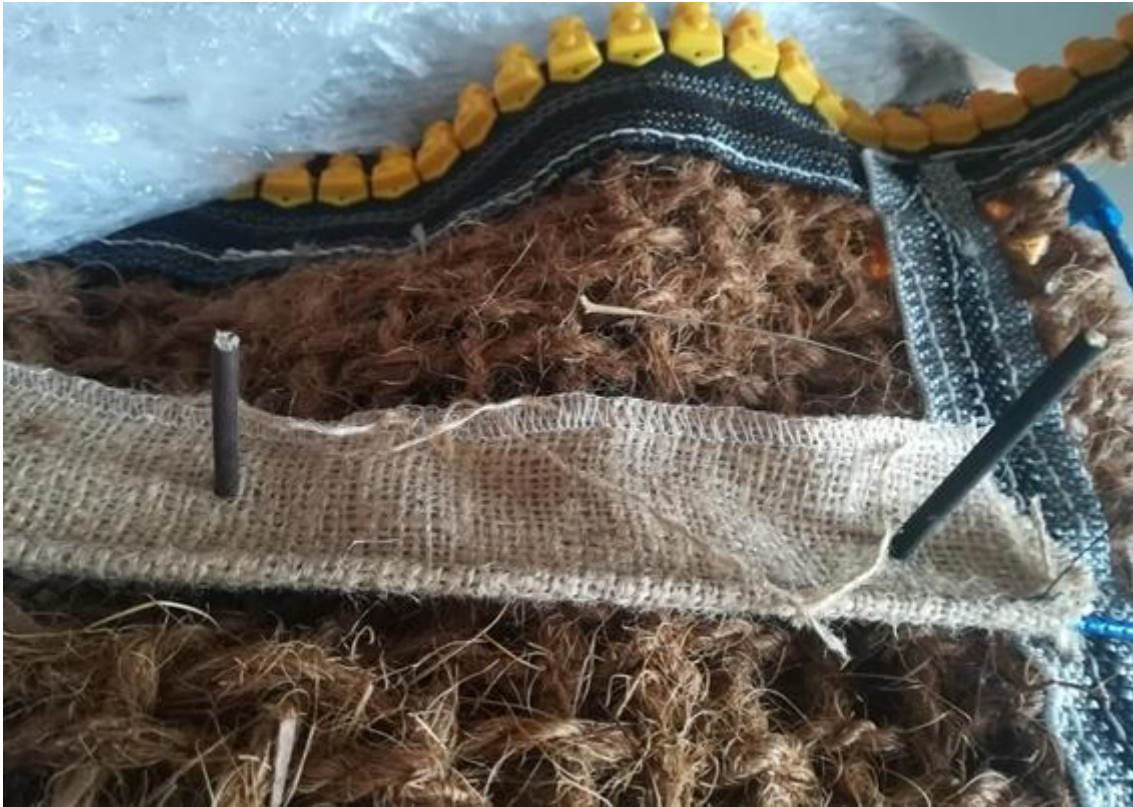
Figura 4-9 Mock-up della soluzione per il fissaggio del tessuto sensorizzato (visibile in blu, all'estrema destra, il sensore in fibra ottica cucito all'interno del tessuto di juta)
