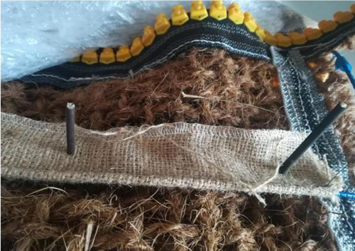
Figura 36: Mock-up della soluzione per il fissaggio del tessuto sensorizzato (visibile in blu, all'estrema destra, il sensore in fibra ottica cucito all'interno del tessuto di juta)
