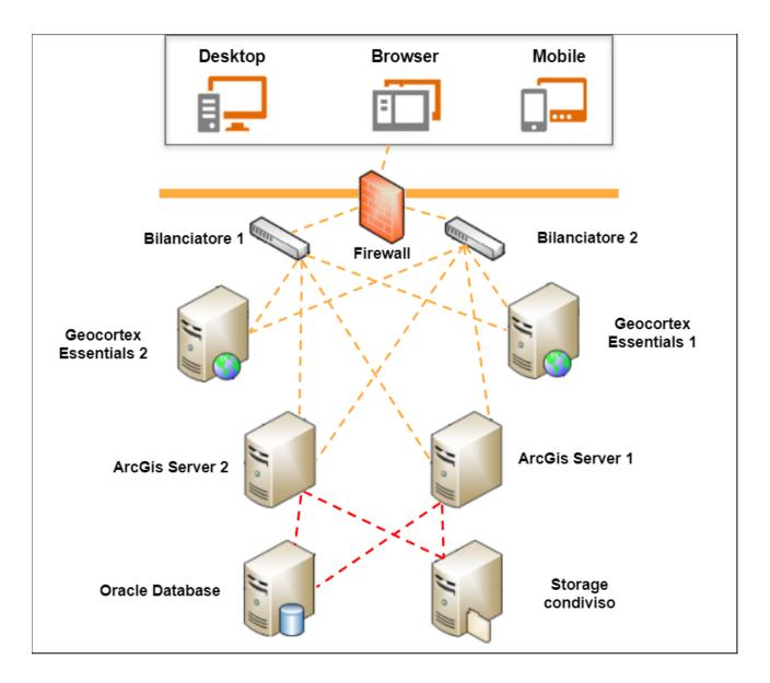
Si precisa che il database Oracle inserito nello schema corrisponde piu' precisamente ad un Oracle Grid Cluster in Rac a 2 nodi con Oracle 12.1.0.2.0 Enterprise edition.
