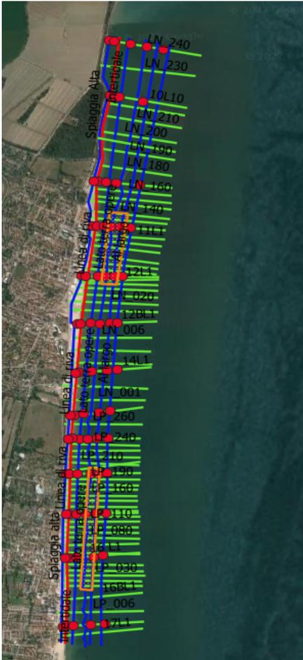
Figura 1. Lido di Pomposa e Lido delle Nazioni: piano rilievo topo-batimetrico, Sapr e campionamento dei sedimenti
