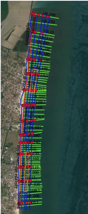
Figura 1 Lido di Pomposa e Lido delle Nazioni: piano di monitoraggio topo-batimetrico e di campionamento dei sedimenti.
