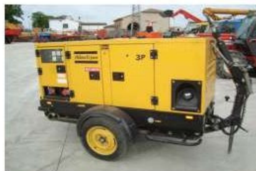
Esempio di gruppo elettrogeno da mettere "a terra"
