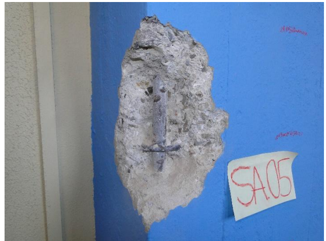
Saggio sulle armature Ivc
