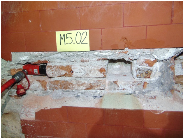
Prova a taglio sulla muratura ST
