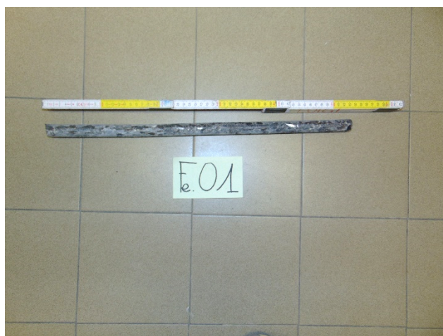
Prelievo di campione di armatura TT
