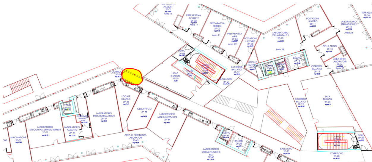
Figura 1. Sede Arpae secondo piano - (giallo) zona di caduta materiale organico da botola sul controsoffitto.
